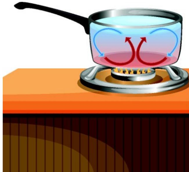
O ar/fluido é um péssimo condutor de calor, porém ele transmite facilmente a energia térmica por convecção.
